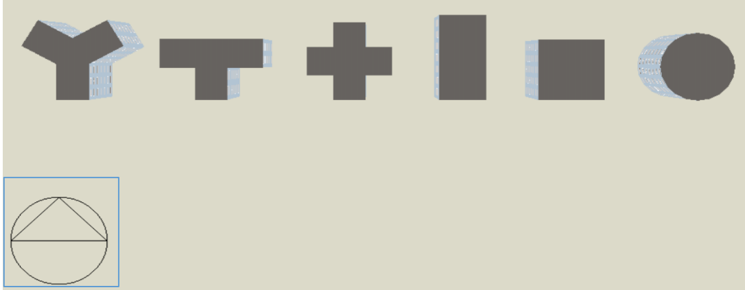
الشكل 4:25 يمثل المسقط الأفقي للنماذج الستة المقترحة خلال محاكاتها باستخدام برنامج المحاكاة DesignBuilder
