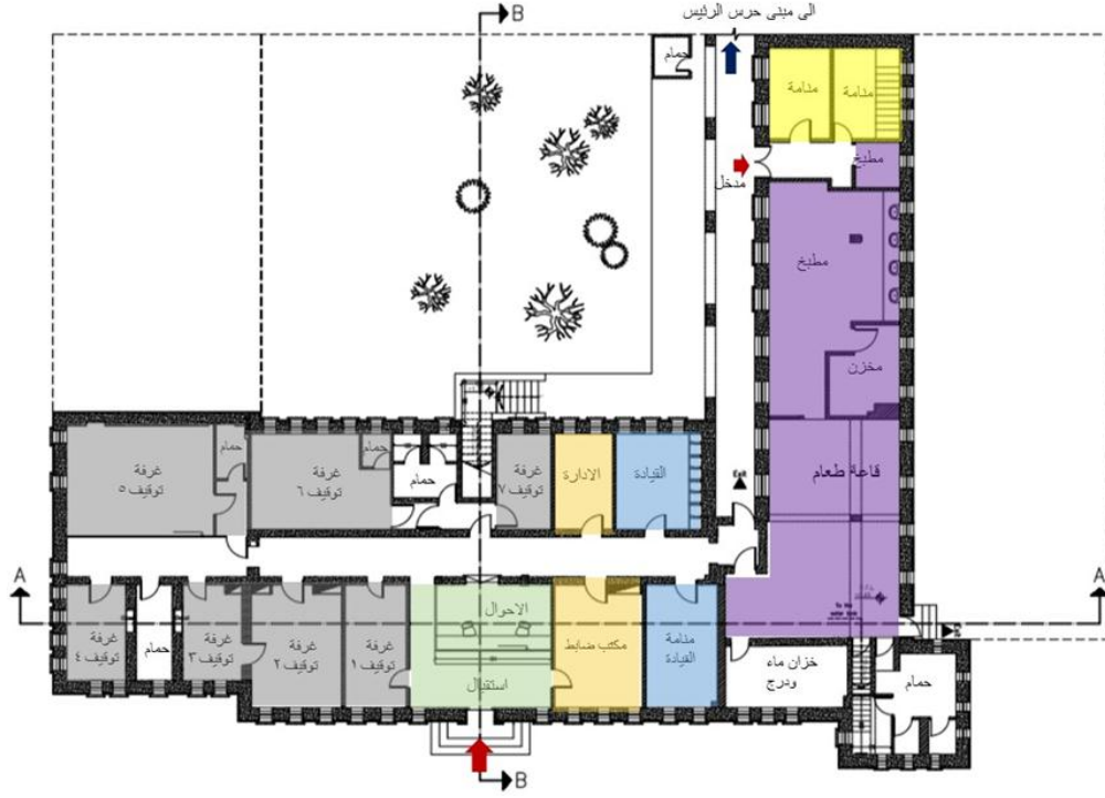
شكل (5-6): المخطط القائم للطابق الأرضي في مركز شرطة الظاهرية. المصدر: وزارة الأشغال العامة والإسكان -
