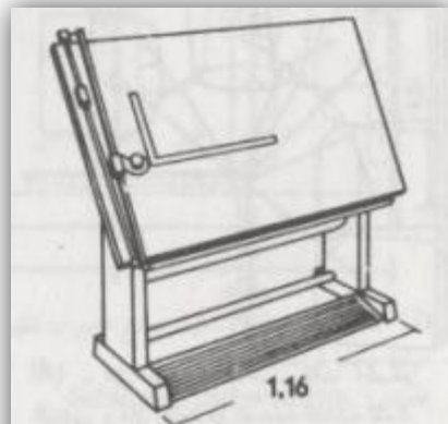
(3) - طاولة رسم مع ذراع متفصل ، ابعاد اللوحة ١٥٠٠ × ١٠٠٠ مم و ١٢٥٠ × ٢٠٠٠ مم ، والارتفاع الاعظمي Kuhlman n م ٢,٠٥
