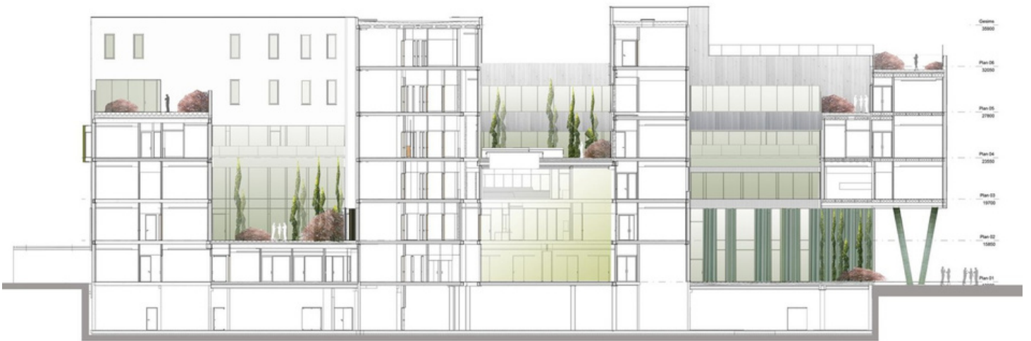
صورة 2. 13 : مقطع يوضح الفراغات الثلاثة التي صمم المبنى حولها مصدر الصورة : www.architecturenorway.no
