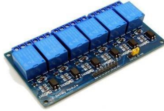
الشكل 20: وحدة الترحيل 6 قنوات
