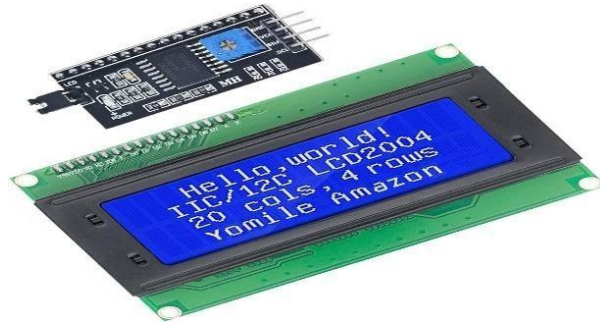
الشكل 12: شاشة LCD 20*4 و I2C
