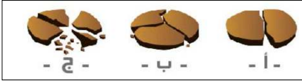
شكل (2: 3): اختبار المقاومة في الحالة الجافة (المصدر: العمارة الترابية. 2010. ص14)
