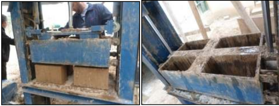
صورة (6: 9): المكبس الهيدروليكي المستخدم في مشروع أسامة حمدان في أريحا. (المصدر: الباحثة.2015)
