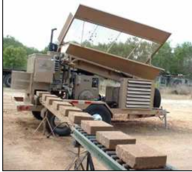
صورة (3: 4): مكبس آلي لإنتاج الطوب الطيني المضغوط (المصدر: http://thenauhaus.com )
