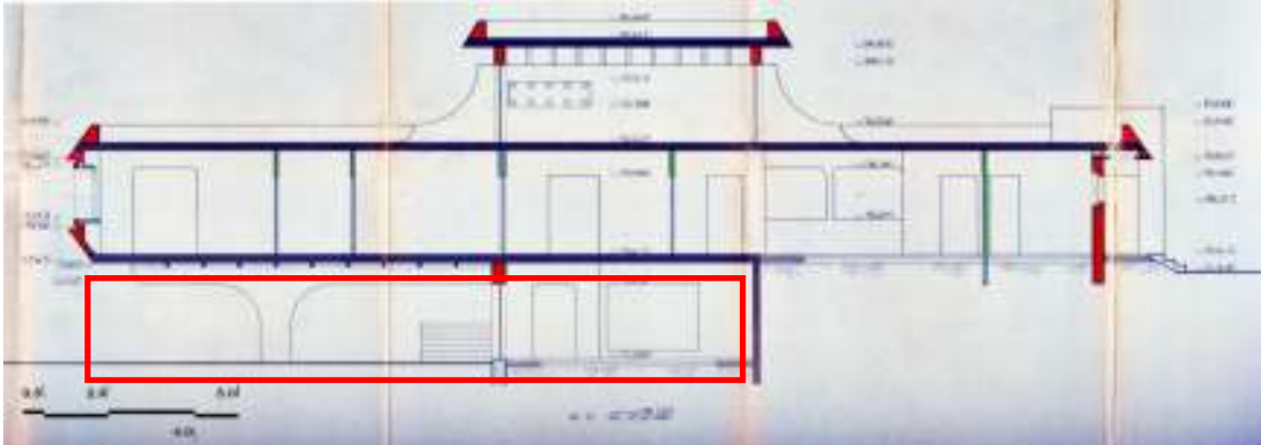
شكل (89): مقطع يوضح فرق المناسيب في الأرض والذي تم استغلاله لزيادة مساحات الترفيه، اللعب والخدمات بالإضافة إلى خلق تدرج فراغي.
