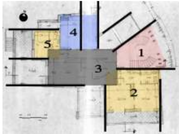
شكل (146): مخطط طابق التسوية حيث يظهر تأثيره بالتكوين الخارجي في توزيع الفراغات الداخلية.
