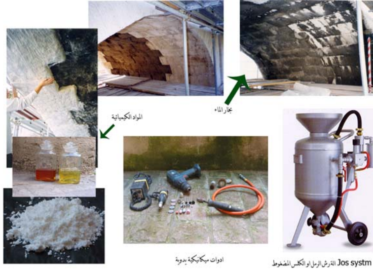
شكل رقم(9): الادوات اليدوية المستعملة للتهيئة قبل التدعيم (Docci, 2005)
