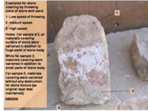
شكل (4:45): تجربة تنظيف الحجر بالرمل باستخدام مضخة بسرعات مختلفة.
