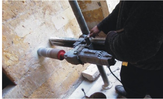
شكل رقم (47): صورة توضح أعمال فحص الحجر في قصر الباشا في غزة. المصدر: مجلة العمران، العدد 45.
