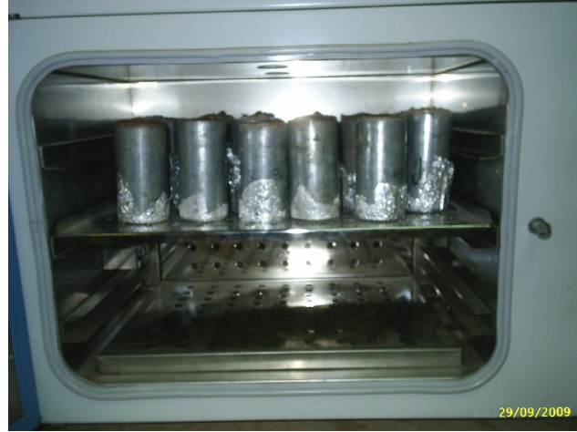
صورة (2): الفرن الكهربائي خلال عملية تجفيف اسطوانات عينات التربة الاساس كمرحلة لقياس مساميتها.
