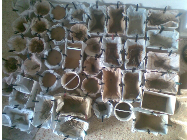
صورة (5): عملية ترشيح المواد المنجرفة قبيل تجفيفها ووزنها.
