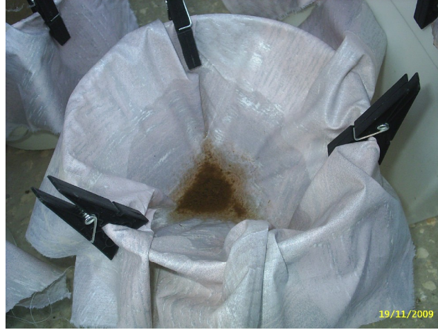
صورة (4): ترشيح المواد المنجرفة لفصل الماء عن التربة بواسطة قطعة قماش خاصة.
