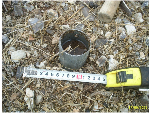
صورة (1): اسطوانة لقياس سرعة نفاذية الماء في التربة ( سعة الرشح الحقلي).
