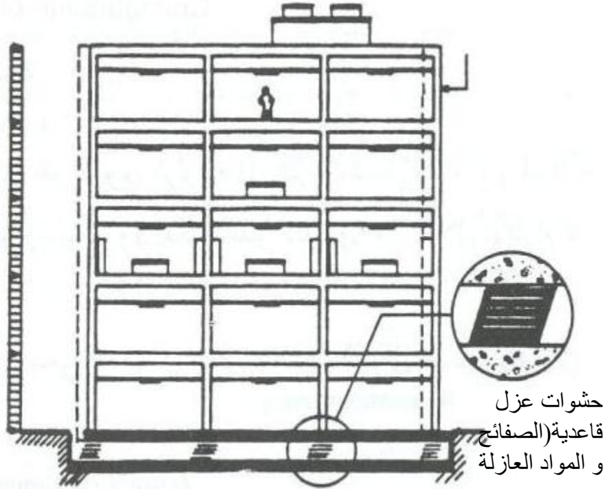
يمكن إهمال الإزاحات الطابقية شكل (٣): منشأ معزول زلزالياً (السماره ٢٠٠٦)
